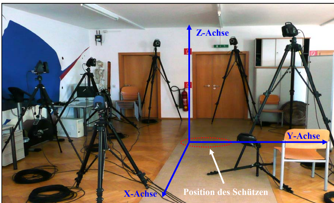
Abbildung 21: Kamerapositionierung und virtuelles Koordinatensystem. Der rot gestrichelte Kreis zeigt die ungefähre Position des Schützen. Das blaue Koordinatensystem zeigt die Ausrichtung des Welt-Koordinatensystems.
